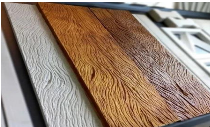
FIGURA 24. REVESTIMENTO COM APLICAÇÃO DA RESINA
